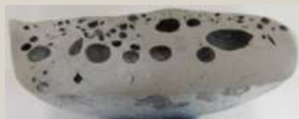
Rysunek 5 Zawartość wodoru w stopie nie poddanym obróbce i w stopie odgazowanym
